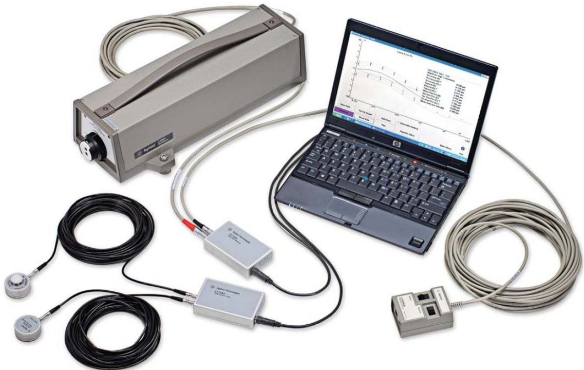
Calibrateur Dynamique Agilent 5530 (PC utilisateur requis, optiques et accessoires non montrés)
